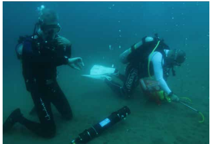
Chercheurs utilisant un capteur pour mesurer les niveaux de CO 2 dans l'océan au niveau des Tropiques. Photo : gracieuseté de Bayani Cardenas
