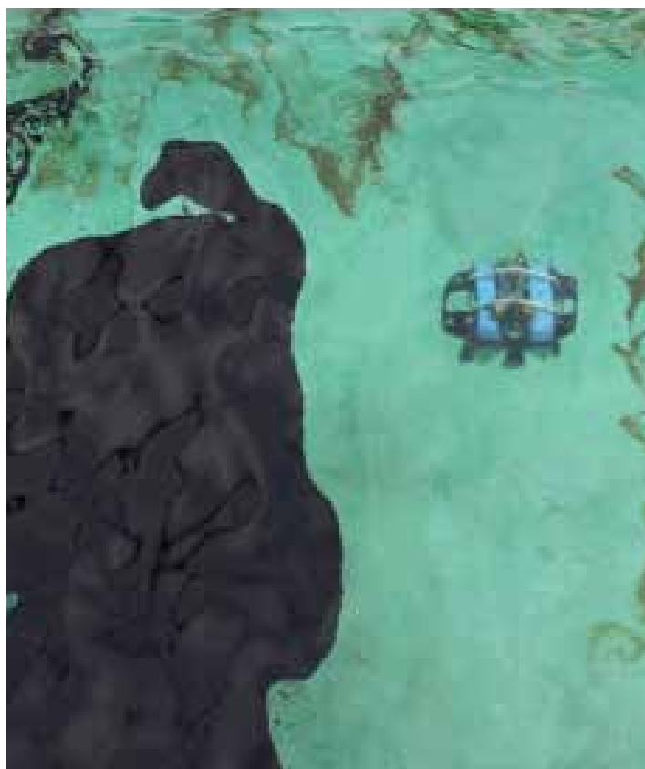
Suivi d'un déversement d'hydrocarbures avec un VTG au réservoir d'Ohmsett dans le New Jersey
