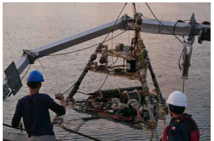
Déploiement d'une plateforme à capteurs à Cambridge Bay, Nunavut pour surveiller sous la glace. Photo : gracieuseté d'Ocean Networks Canada.
