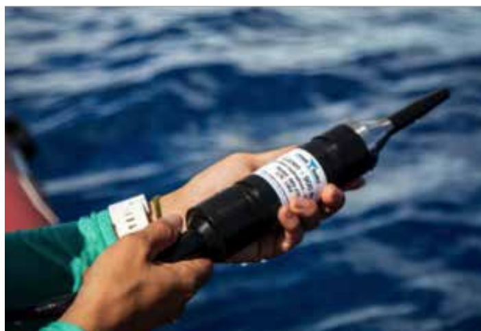
Un chercheur déployant l'hydrophone icListen. Photo : Ocean Sonics
