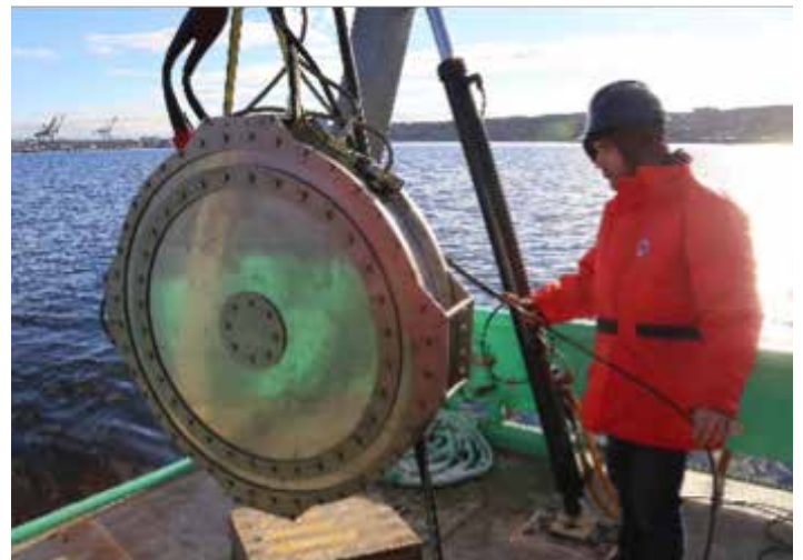
Voici des transducteurs C-Bass. Ils peuvent émettre des sons à très basse fréquence et même jouer de la musique rock dans l'eau. Photos : gracieuseté de GeoSpectrum Technologies Inc.
